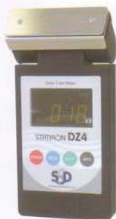
DZ4 プレート(オプション) 型式:ODZ4-PLT イオナイザーのイオンバランスの計測ができます。
